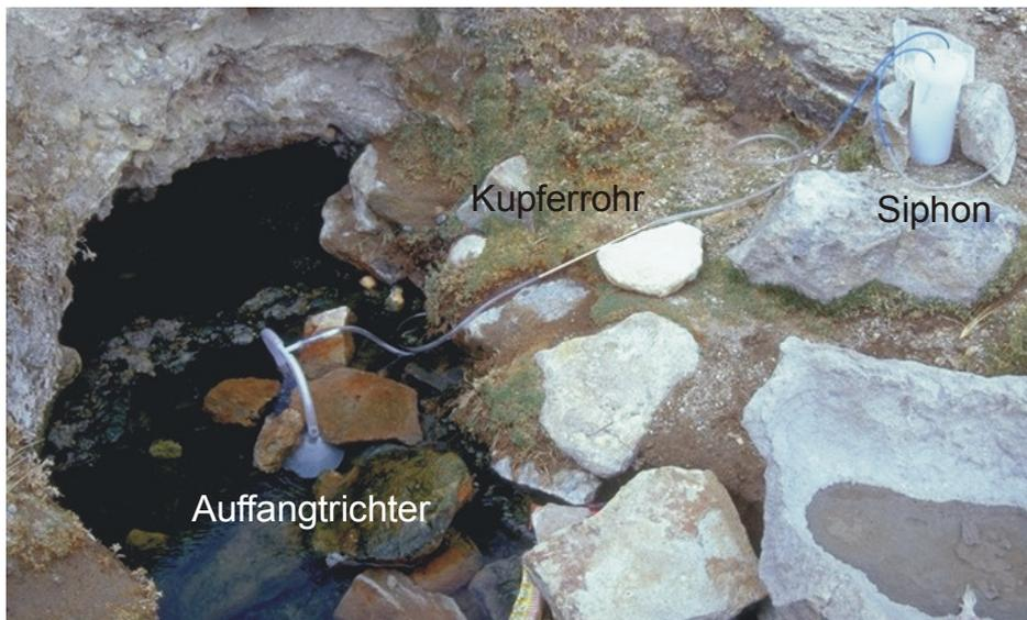
**Abb. 37:** Bei der Gasprobennahme mittels Durchflussmethode wird das Gas in ein oder zwei Trichtern aufgefangen und über einen Schlauch durch das Kupferrohr und einen mit Wasser gefüllten Siphon geleitet. Nach angemessener Spülzeit wird das Kupferrohr mit einem modifizierten Bolzenschneider beidseitig zugequetscht. (Lokalität Pompeja)
