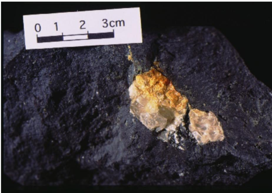
**Abb. 12:** Das Foto zeigt einen cm-großen rekristallisierten Quarz-Einschluss in der Probe An 74.
