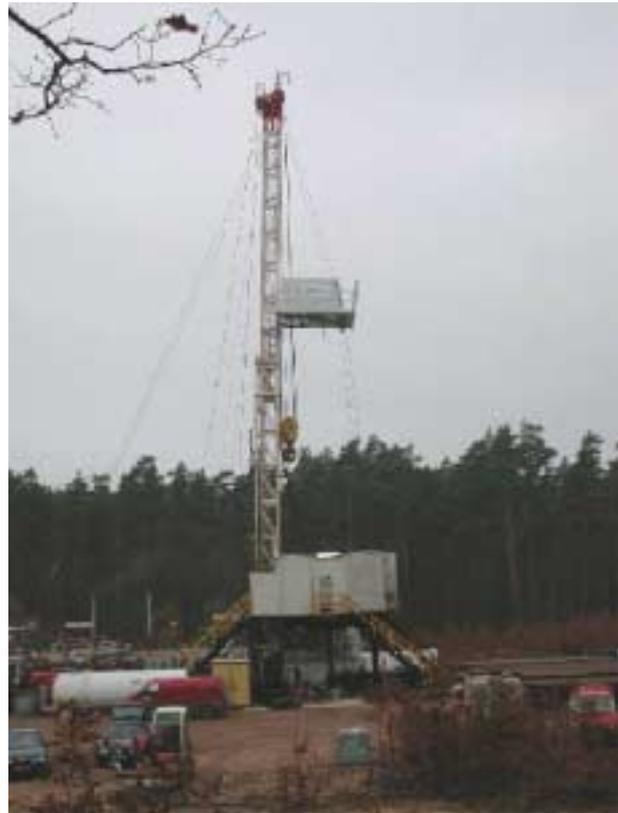
**Abbildung 4:** Bohranlage Cabot Franks 900 am Standort Groß Schönebeck / Cabot Franks 900 drilling rig on Groß Schönebeck site
