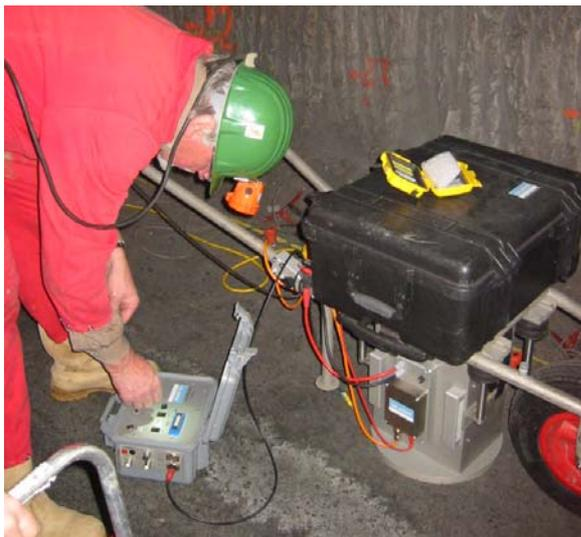
Abb. 2.4-2: P-Wellen Vibrator für Quellentest
