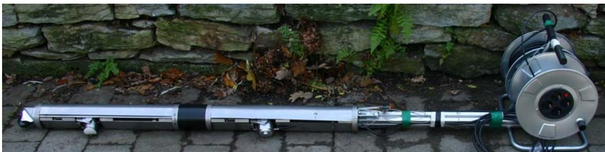
Abb. 4-3: Bohrloch-Sonde mit hochempfindlichem Ultraschallaufnehmer und mit Piezo-Aktuator für Messungen mit aktivem niederfrequentem Ultraschall in Trockenbohrungen
