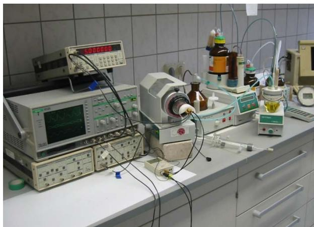
Messplatz der Simultanmessungen mit Aufbau Elektrik, Trocknungsofen und Karl-Fischer-Titration
