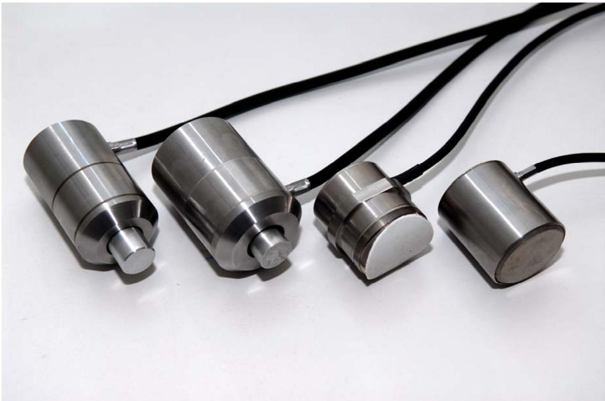
Abb. 4-1: Am Fraunhofer IZFP Dresden entwickelte Aktuator-Sensor-Kombinationen für Sonar-Messungen am Stoss und in Bohrungen
