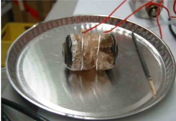
Das nebenstehende Foto der Probe Teu/+160m dokumentiert die spröde Brüchigkeit der Steinsalzproben. Diese Zylinderprobe wurde aus einem Handstück gebohrt und mit Anschlüssen für die elektrische Widerstandsmessung versehen (Stromelektroden an den Zylinderflächen, Spannungsmessung an beiden Ringelektroden um die Mantelfläche).
