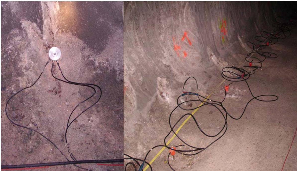
Abb. 2.4-1: Dreikomponenten Piezoschwinger und vertikale Einkomponentengeophone
