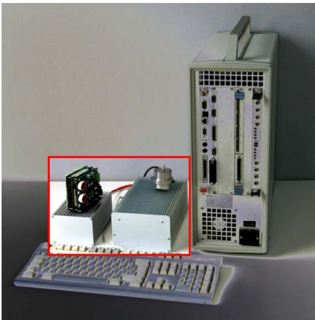
Abb. 4-4: Größenvergleich eines Prototyps des neu entwickelten bergbautauglichen 16-kanaligen Ultraschall-Messsystems (rot) mit dem bisher eingesetzten System AE.engine (rechts).
