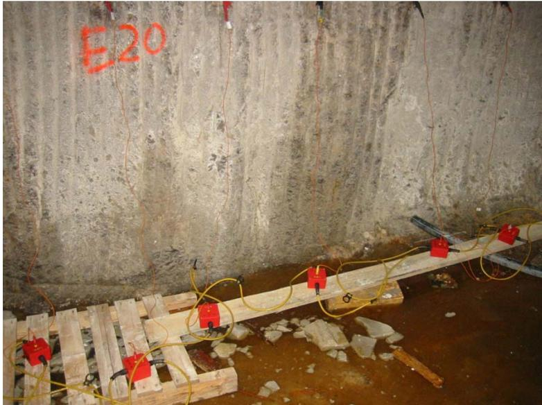
Abb. 2.1-18: Situation im Juli 2007 am westlichen Profilende. Die Elektroden befinden sich in ca. 1,2 m Höhe am Stoß, auf der Sohle sind großflächige Laugenpfützen.
