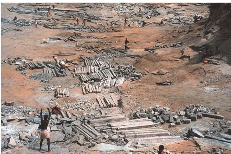
Abb. 3-4: Steinbruch zur Zaunpfahl-Herstellung etwa 25 km südlich von Coimbatore (Augengneise PS-I 114, Palghat-Scherzone).
