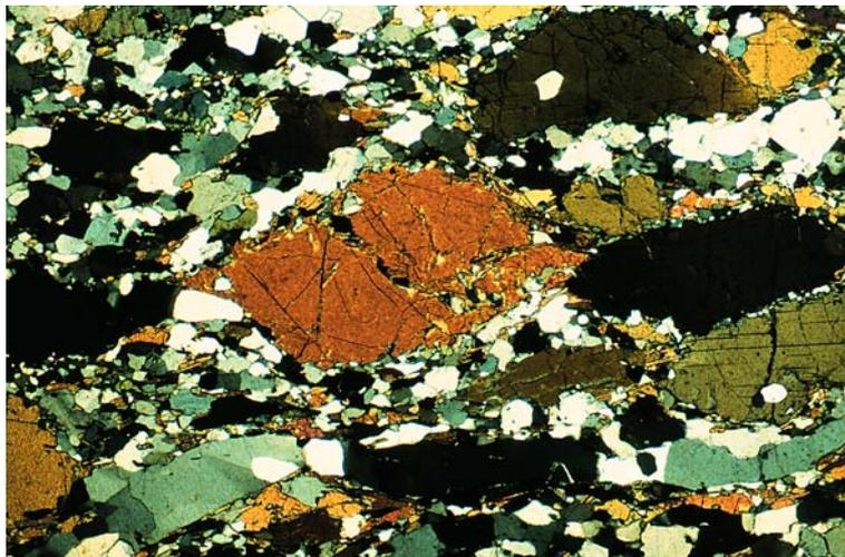
Abb. 3-16: Hbl-Gneismylonit (retrograd überprägter Enderbit) MS-I 135A (gekreuzte Nicols). Hornblende-Sigmaklasten treten in einer Feldspat-reichen Matrix auf.
