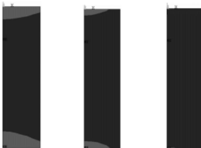
Abbildung 5-5: Dilatanzkriterien nach Spiers, Hunsche und Ratigan am Bohrkern unter einaxialer Belastung (dunkelgrau: Kriterium erfüllt - Rißbildung)
