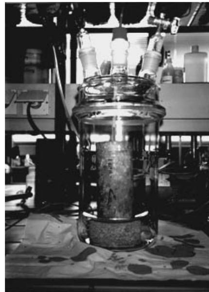
Abbildung 5-7: Einfärbung von Steinsalzkernelementen unter Vakuum
