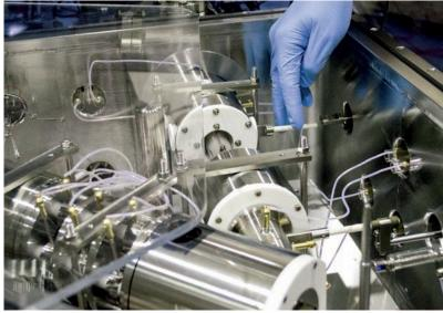
Widok na odkrytą komorę źródła jonów SHRIMP IIe/MC, z kolumną pierwotną z położeniem apertur Köhlera (patrz: dłoń), i z kolumną jonów wtórnych, prowadzącą w kierunku analizatora elektrostatycznego (w lewą stronę).
