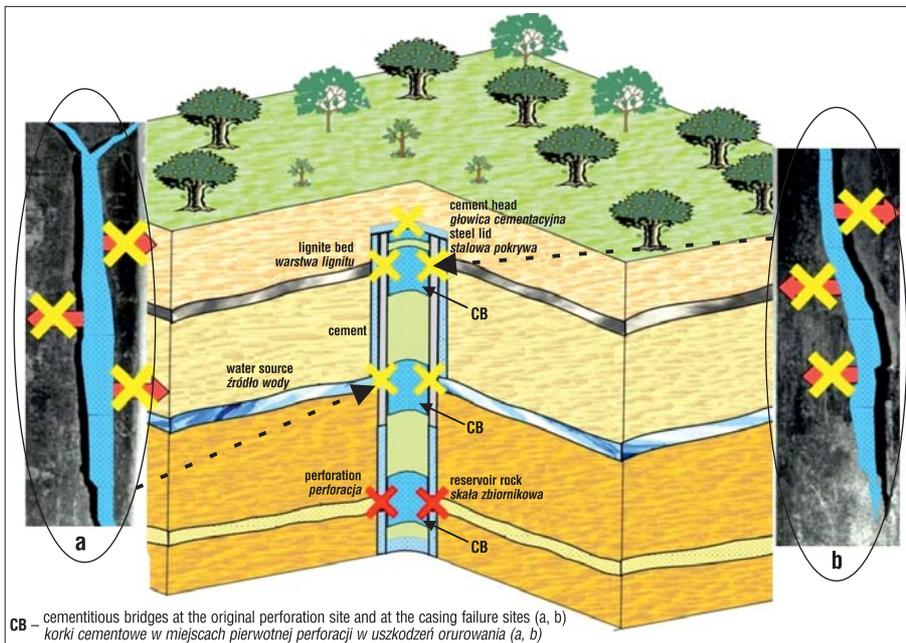
**Fig. 6.** An exemplary professional abandonment of an old exploitation well (Propagační materiál PKÚ, 2014)
