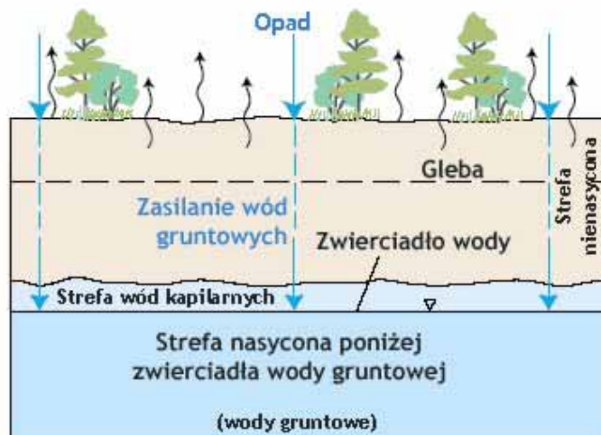
Rys. 9. Retencjonowanie wody podziemnej
