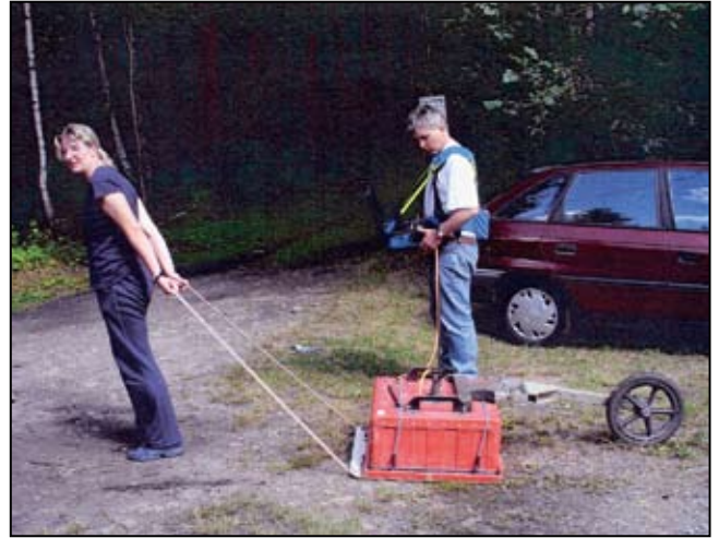
Fig. 2. Badania przypowierzchniowych struktur geologicznych za pomocą aparatu „Georadar” prowadzone przez Ute Baron i dr Hellfrieda Petzolda
