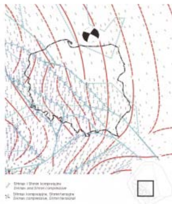
Fragmenty modelu numerycznego Europy Środkowej prezentujące wyniki obliczeń wielkości i kierunków naprężeń tektonicznych; „piłka plażowa” pokazuje zgodność mechanizmu ogniska wstrząsu sejsmicznego w Kaliningradzie z wynikiem modelowania
