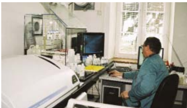
Spektrometr ICP-MS do oznaczania pierwiastków śladowych i mikrośladowych w próbkach geologicznych i środowiskowych
