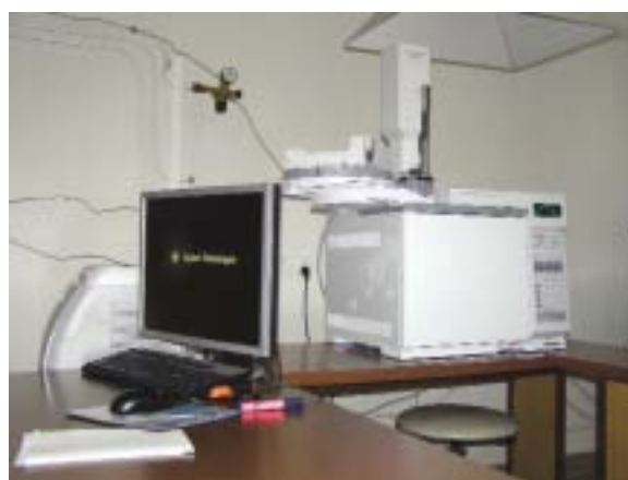
Chromatograf gazowy GC-ECD do oznaczania pestycydów
