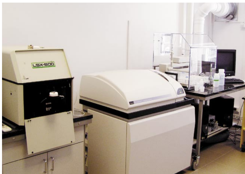
Spektrometr ICP-MS do oznaczania pierwiastków śladowych i mikrośladowych w próbkach geologicznych i środowiskowych
