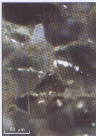
Inkluzje fluidalne (węglowodorowe) w arenicie kwarcowym środkowego kambru; obraz we fluorescencji (uV); otwór B8-1, głębokość 2199,5 m Fluid inclusions (of hydrocarbon type) in the Middle Cambrian quartz arenites; image in fluorescence light (uV); borehole B8-1; depth of 2,199.5 m
