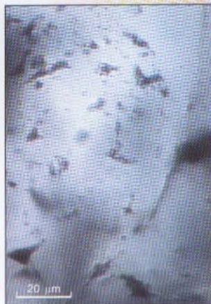
Dwufazowe inkluzje węglowodorowe w arenicie kwarcowym środkowego kambru; obraz w świetle mieszanym; otwór B2-1, głębokość 2487,35 m Two-phase hydrocarbon inclusions in the Middle Cambrian quartz arenites; image in mixed light; borehole B2-1; depth of 2,487.35 m
