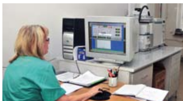
Chromatograf gazowy z detektorem, spektrometrem mas i analizatorem fazy nadpowierzchniowej GC-MSD / Headspace (5973 / 7694E)
