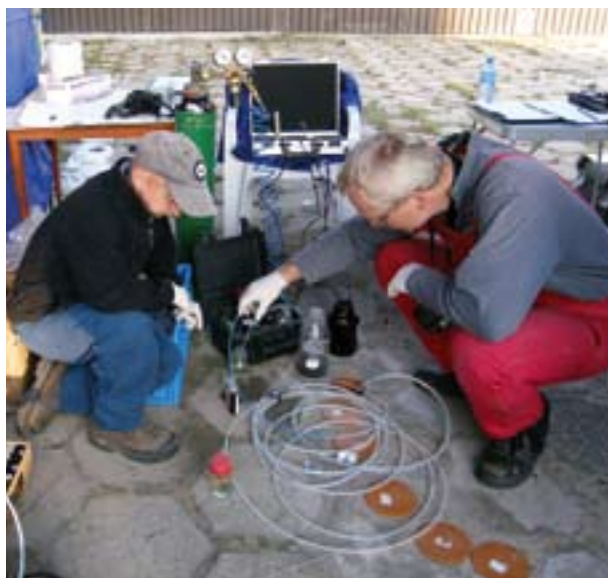
Pobór próbek wody z piezometrów typu CMT do testowania fotometru
