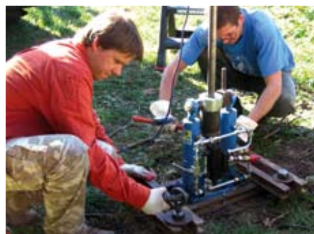
Badania geologiczno-inżynierskie w wąwozie lessowym – pomiary elektrooporowe stożkiem elektrycznym; Kazimierz Dolny n. Wisłą
