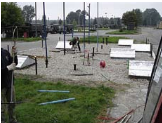
Pobór próbek wody z piezometru w sąsiedztwie podziemnych zbiorników paliwowych
