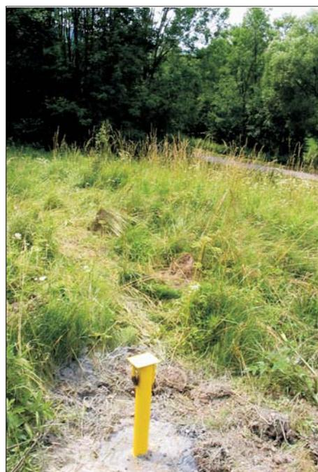
Fig. 20. Standpipe piezometer, Sękowa
