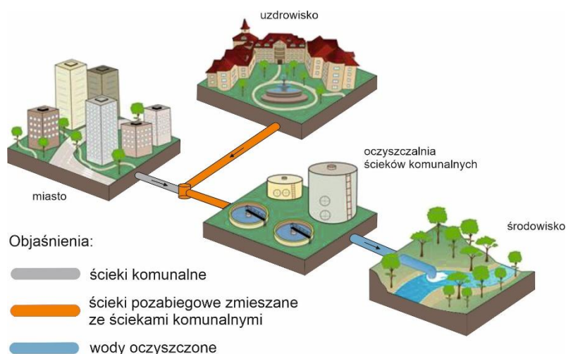
Fig. 9.1. Schemat nieprawidłowego sposobu odprowadzania ścieków pozabiegowych (na podst.: Raport Najwyższej Izby Kontroli, 2015 oraz Mapa wód podziemnych zaliczonych do kopalin w Polsce wg stanu na 31 XII 2021, Tekst objaśniający do mapy w skali 1:1 000 000, 2022)
