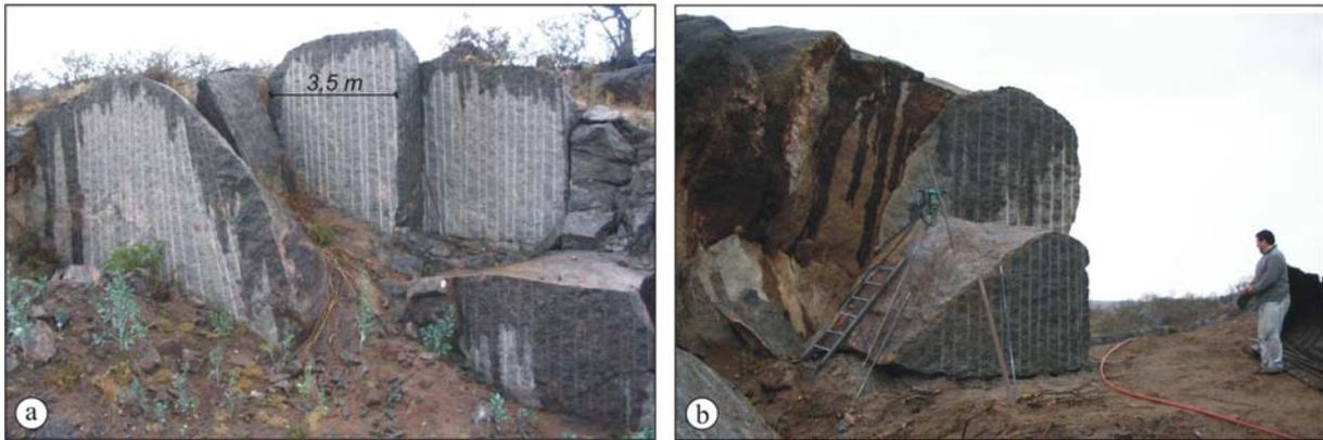
Abb. 4.7: a) Typische Aufschlussituation im Granitkomplex El Pilón; b) die zeitintensive Aufarbeitung einzelner Boulder ist zumeist mit einem erhöhten Abraumanteil verbunden (Steinbruch Fa. Agrimar).
