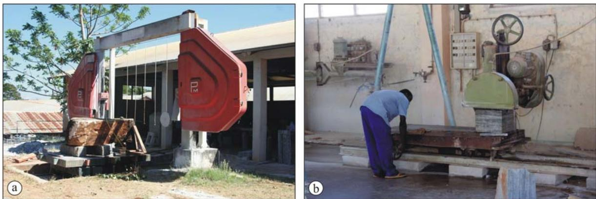
Abb. 5.5: Marmorverarbeitung in der Kirchenmission Ndanda mit a) Blockseilsäge und b) manuell gesteuertes Brückensäge. Links im Hintergrund ist die Wandarmschleifmaschine montiert.
