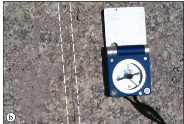
Abb. 2.23: a) CEZLAK GRANODIORIT (Slowenien): farblich abgesetzte Aplitgänge bestimmen das charakteristische Dekor des Gesteins; b) ROSA DEL SALTO (Granit, Argentinien): potenzielle Schwächezone durch mineralisch geschlossene Klüfte als zu beachtendes Element des Trennflächengefüges.
