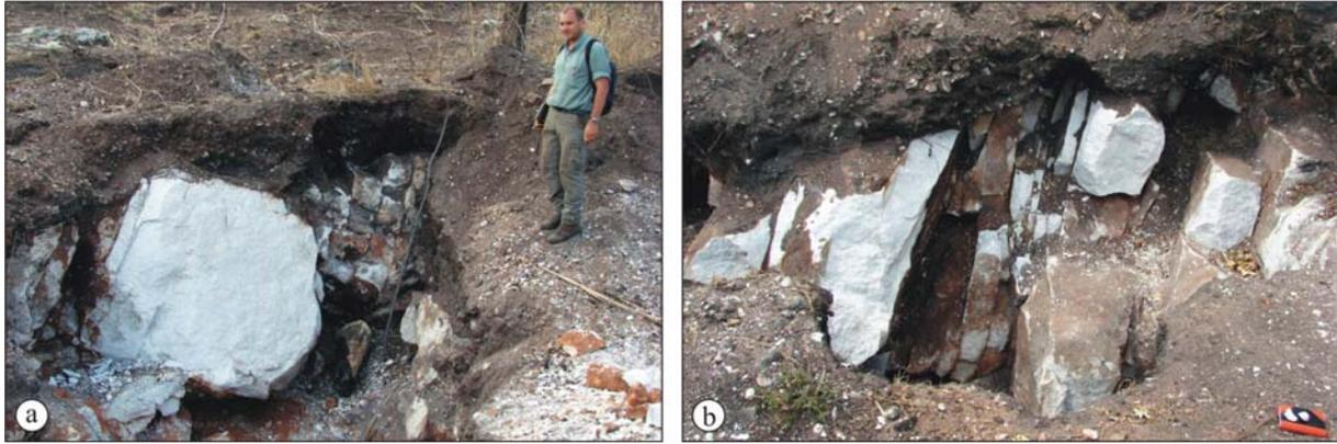
Abb. 5.18: a) Bereits oberflächennah treten vereinzelt größere, annähernd quaderförmige in-situ Blöcke auf. b) Die Rohblockhöflichkeit wird durch wiederholt auftretende engständige Kluftscharen herabgesetzt.
