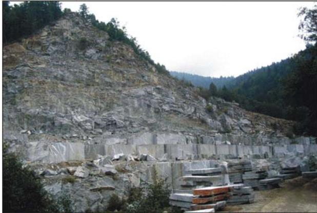
Abb. 2.5: Steinbruch der Handelssorte CEZLAK GRANODIORIT (Slowenien): Im Hangenden ist eine erhebliche Zergliederung gegeben, während im unteren Bereich ein kompakter Gesteinskörper ansteht.
