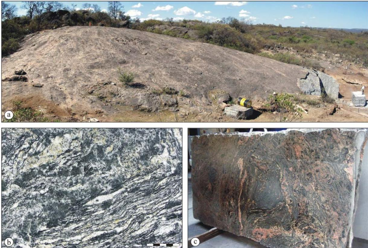
Abb. 4.10: a) Großvolumige, massive Boulder erlauben eine hohe Ausbringung gut dimensionierter Rohblöcke beim Abbau des migmatitischen Paragneisses FRANCO VETEADO (Provinz Córdoba, Cruz del Eje, Steinbruch Fa. Minera Ruma Huasi). b) FRANCO VETEADO mit deutlichem Wechsel von Paläosom und Leukosom sowie Bereichen einer verstärkten Anatexis (Maßstab in cm); c) Farbvarietät ROJO FRANCO VETEADO (polierte Oberflächen).
