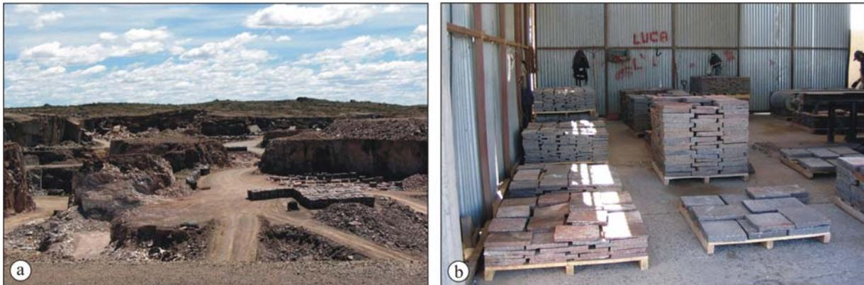
Abb. 4.29: a) Werksteinbruch „Namuncurá“ (Porphy, Sierra Chata, Provinz Chubut): eine erste Auswahl und Sortierung des ausgebrachten Materials erfolgt bereits Vorort; b) die weitere Klassifikation (Färbung, Stärke, Größe) nach Bearbeitung im Werk.
