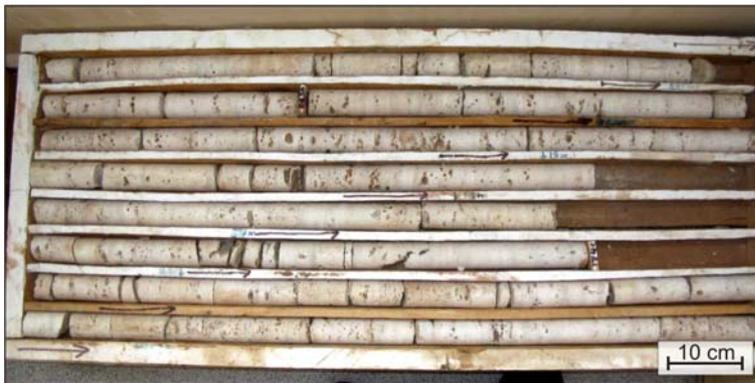
Abb. 3.44: Vertikaler Bohrkern aus einer Travertin-Lagerstätte in der Provinz San Juan, Argentinien. Deutlich ist der lagenweise z.T. sehr heterogene Charakter des Porenraumes zu erkennen.
