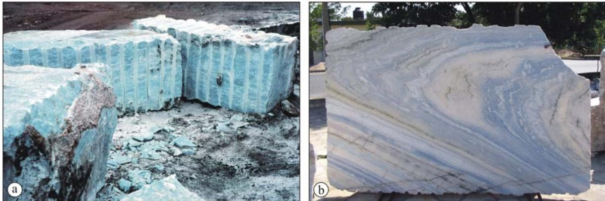
Abb. 4.25: Calcitische Marmorvarietät AZUL CIELO (Provinz Córdoba): a) ausgebrachte Rohblöcke (Foto: Fa. Altamar S.R.L.) und b) polierte Unmaßtafel.
