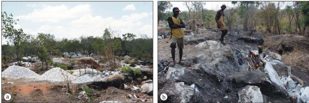
Abb. 5.4: a) Intensiver Kleinstbergbau im Lagerstättenbereich E' Mtesa. b) Zerkleinerung freigelegter massiver Bereiche mittels Feuersetzen.
