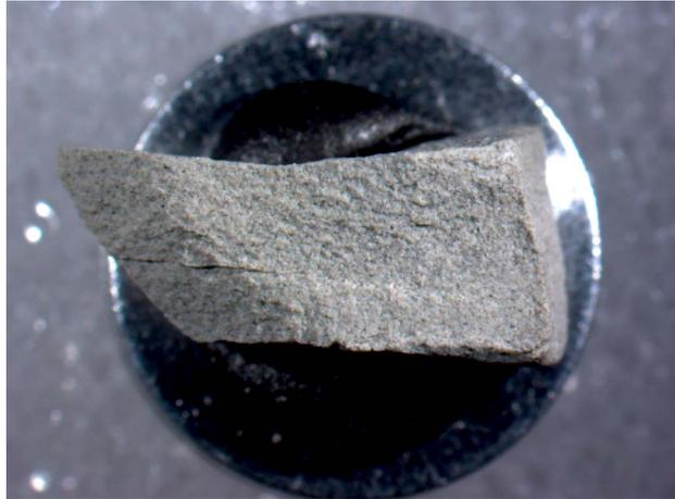
**Abb. 4.6:** REM-Präparat mit frisch erzeugter Bruchfläche. Durchmesser des Probenhalters 12 mm.
