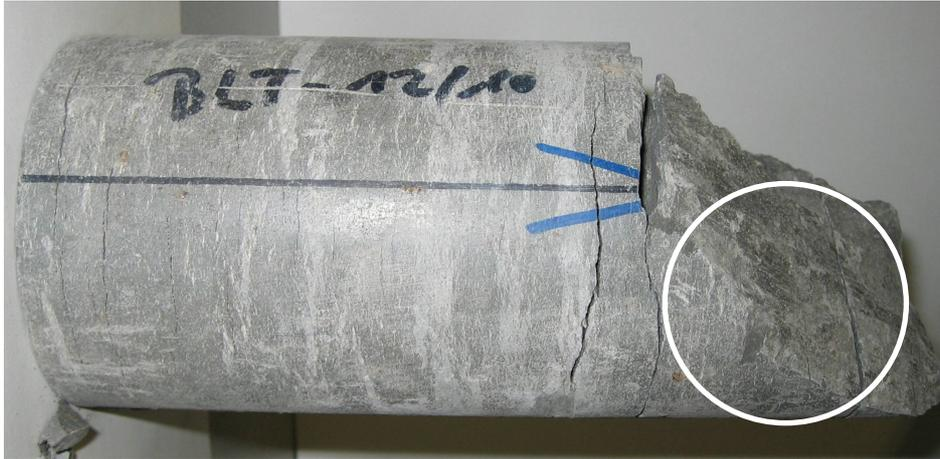
**Abb. 4.3:** Bohrkern nach mechanischem Test. Die Markierung zeigt am Beispiel der Probe BLT 12/10 eine Stelle zur Probeentnahme für die mineralogischen und optischen Untersuchungen.
