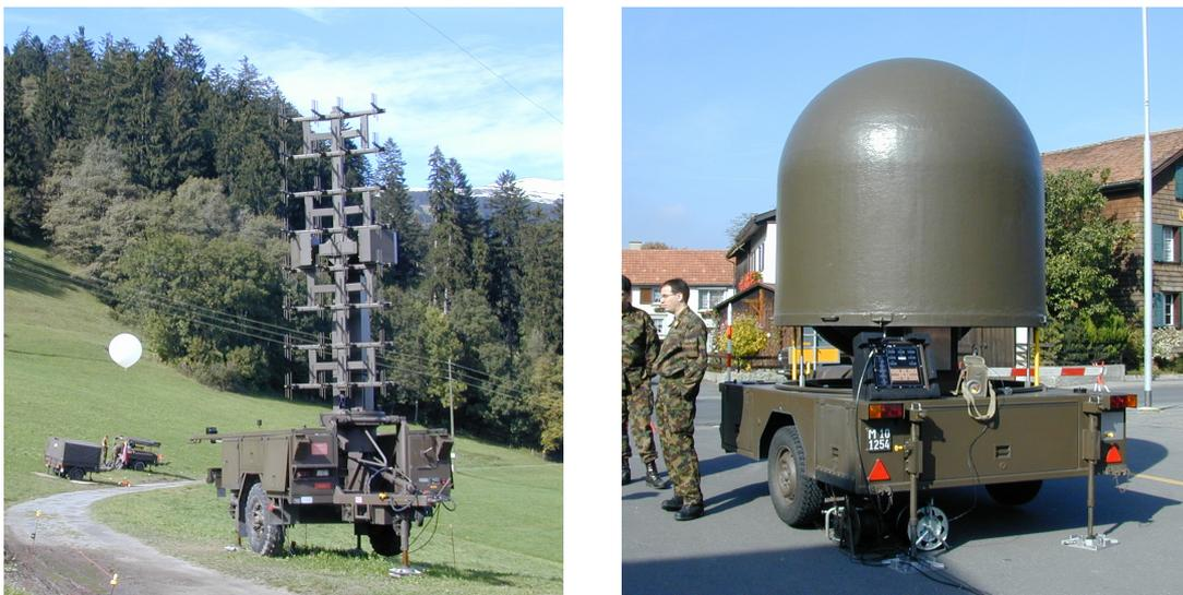
Fig. 2.4: Die Empfangs- und Sendeantennen der militärischen Radiosondenanlagen. Links: P-760; Rechts: P-763 (mit angehobener Schutzhaube).
