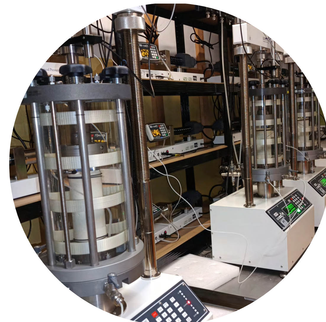
Aparatura badawcza wykorzystywana w laboratorium CBGS do oznaczania parametrów wytrzymałościowych na potrzeby charakterystyki serii litologiczno-genetycznych
