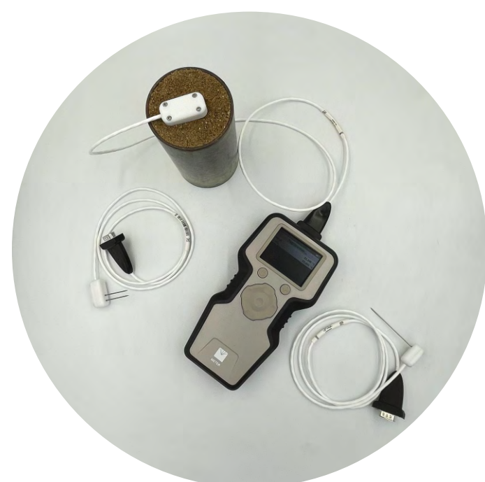
Analizator właściwości termicznych wraz z zestawem sond igłowych do badania skał i gruntów w stanie nieustalonym
