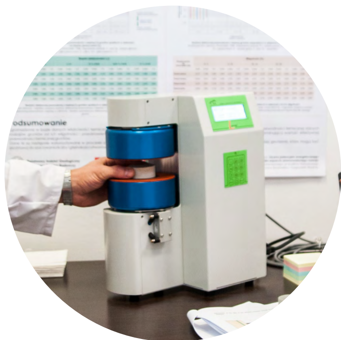
Sonda stacjonarna typu FOX do badania skał w stanie ustalonym
