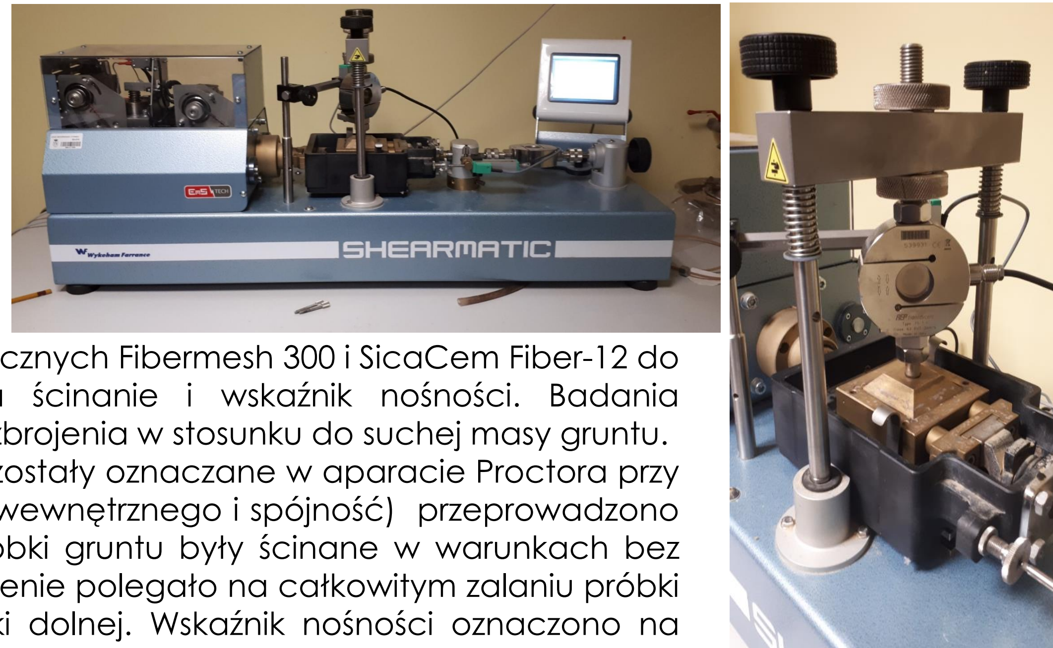
Rys. 1. Aparat bezpośredniego ścinania
