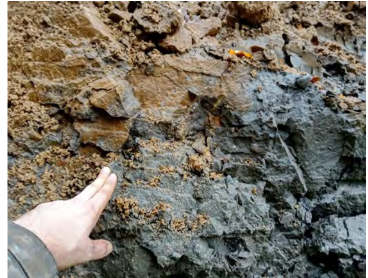
Gliny lodowcowe brązowe i szare w wykopie na terenie Kampusu Ochota, głęb. ok. 5 m (fot. P. Zawrzykraj) Brown and grey glacial tills in the excavation at the Ochota Campus of the University of Warsaw, depth c. 5 m
