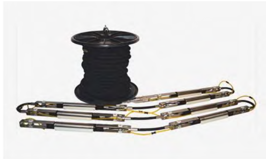
Po lewej odbiorniki fali P – BHC5. Po prawej odbiorniki fali S – MBAS-D.
