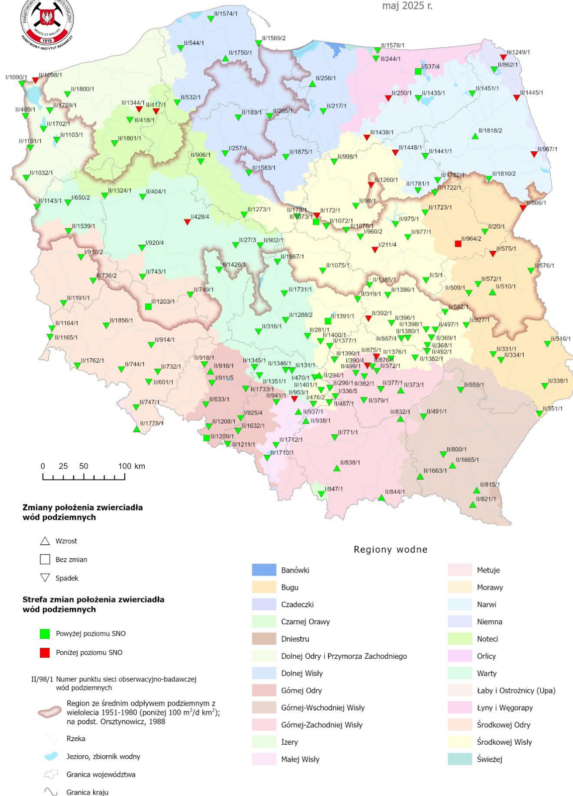
Ryc. 4. Zmiana położenia zwierciadła wody podziemnej w objętych analizą punktach sieci obserwacyjno-badawczej wód podziemnych w maju 2025 r.
