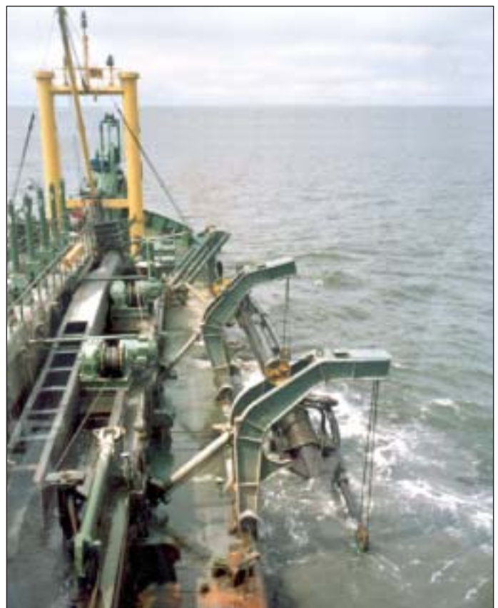
Pogłębiarka ssąco-refulująca w czasie pracy na złożu kruszywa żwirowego na Ławicy Słupskiej
