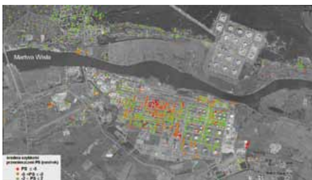
Osiadanie zarejestrowane metodą satelitarnej interferometrii radarowej na obszarze Rafinerii Gdańskiej (Grupa Lotos S.A.)
