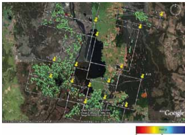
Dane satelitarnej interferometrii radarowej z rejonu Szczecina; widoczne osiadanie powierzchni terenu w różnych częściach doliny Odry
