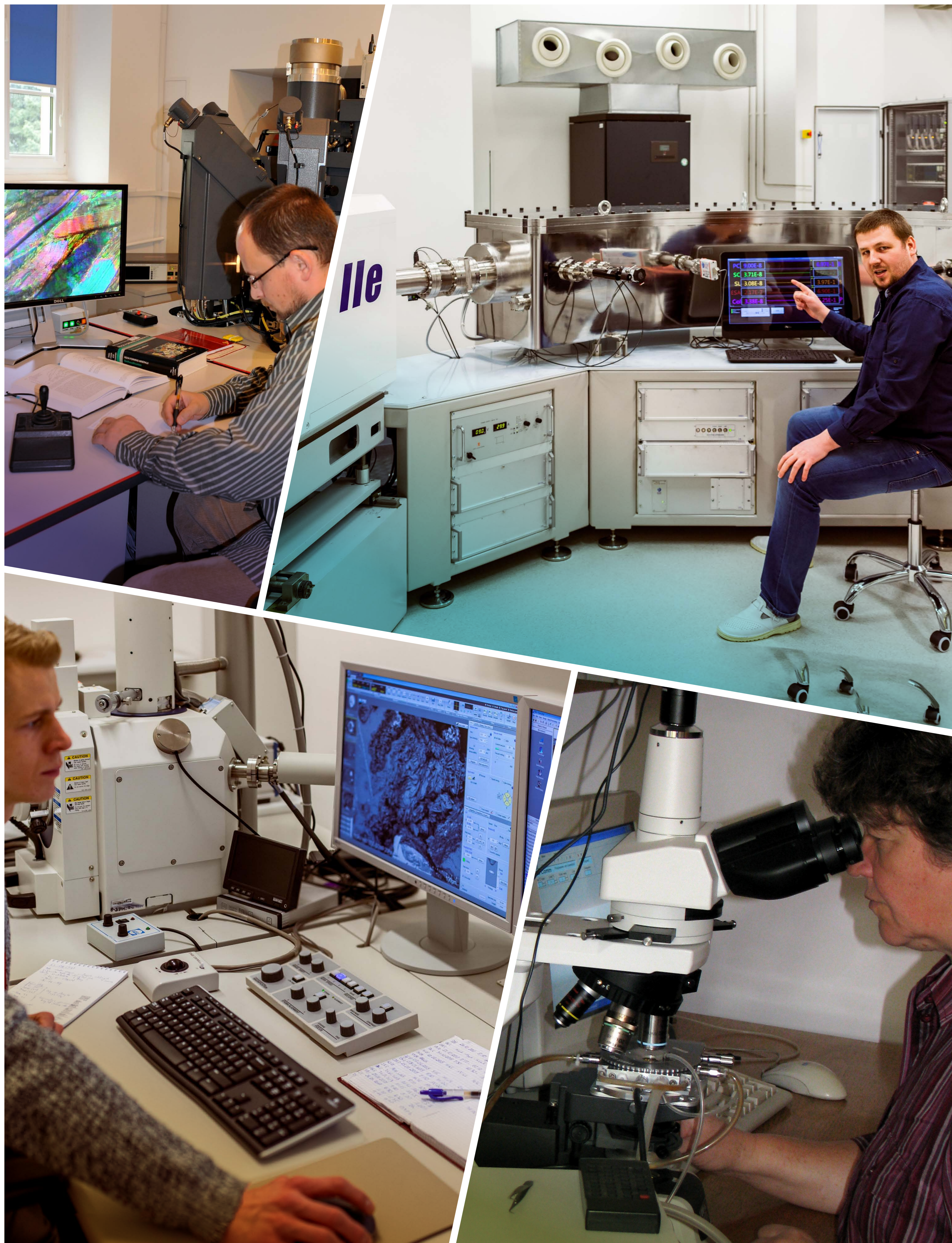
Fot. 1. Mikrosonda elektronowa CAMECA SX100 specjalizująca się w wykonywaniu precyzyjnych analiz chemicznych; Fot. 2. Wysokorozdzielcza mikrosonda jonowa SHRIMP IIe/MC, precyzyjny spektrometr mas wykonujący pomiary wybranych stosunków izotopowych z zachowaniem naturalnej mikroskali przestrzennej próbki; Fot. 3. Mikroskop skaningowy HITACHI SU 3500, model ze zmienną próżnią tzw. środowiskowy, na którym badane jest powierzchnia próbki w stanie niezmiennym; Fot. 4. Mikroskop polaryzacyjny do światła przechodzącego, odbitego i do badania inkluzji fluidalnych.
