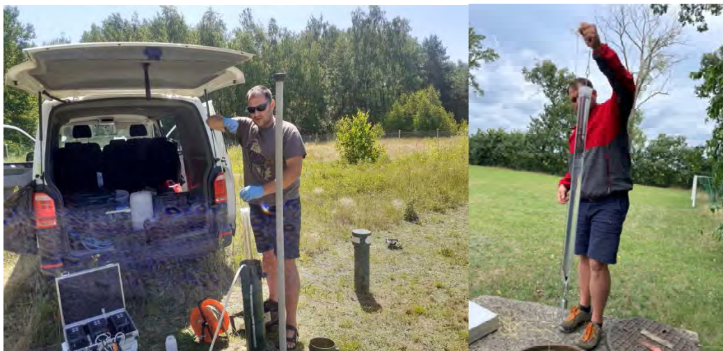
Fot. 7.1.1. Pobór próbek wód podziemnych metodą bezpompową „no purge sampling” z wykorzystaniem rękawowego dyskretny próbnika pasywnego HydraSleeve® (punkt monitoringowy SOBWP I/920/2 Granica oraz SOBWP II/567/1 Międzyłесь)
