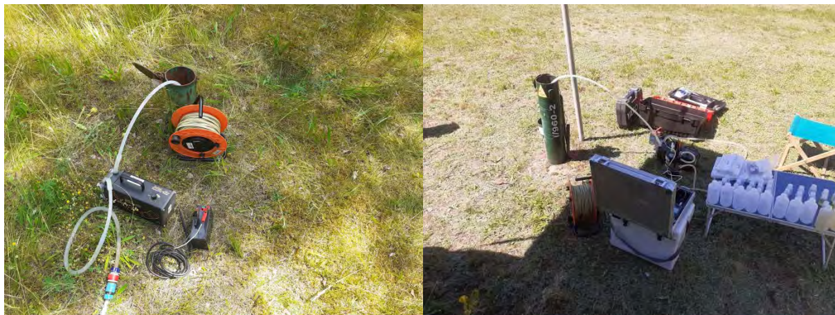
Fot. 7.2.1. Pobór próbek wód podziemnych z pompowaniem z minimalną wydajnością w reżimie „low flow” – elektryczna pompa perystaltyczna (LF) (punkt monitoringowy SOBWP II/707/1 Hel oraz SOBWP I/920/2 Granica)
