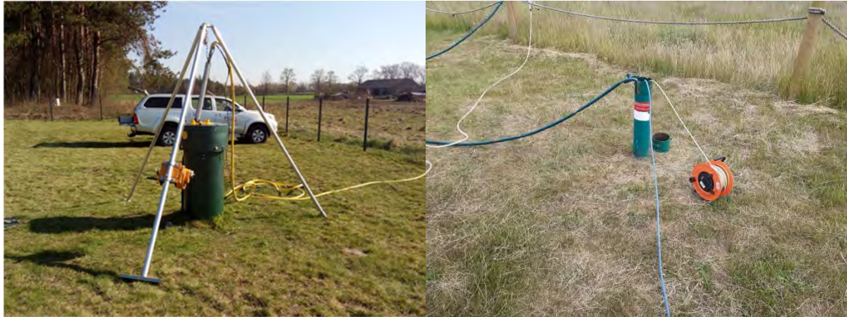
Fot. 7.3.1. Pobór próbek wód podziemnych metodą konwencjonalną (pompowania oczyszczające – wolumetryczne) z wykorzystaniem zanurzeniowej pompy wirnikowej – odśrodkowej (RP) (punkt monitoringowy SOBWP I/704/2 Lubochenek oraz SOBWP II/1751/1 Kluki)
