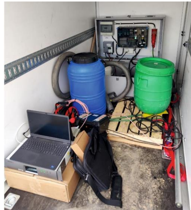
Widok rejestratora optycznego - reflektometr AP Sensing N45-series
