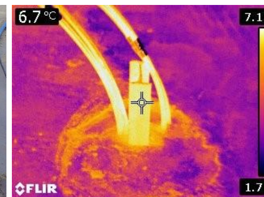
Widok gotowego termopala z podwójną U-rurką (a) oraz jego zbliżenie wykonane w termowizji z wykorzystaniem kamery Flir (b), widoczny obrys pala i rurki polietylenowe o podwyższonej temperaturze
