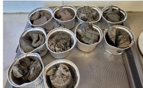
Przykład wyników cyklicznych badań w aparacie trójosiowym źródło: Dokumentacja geologiczno-inżynierska NAG, Nr.Inw. 8207_2020
