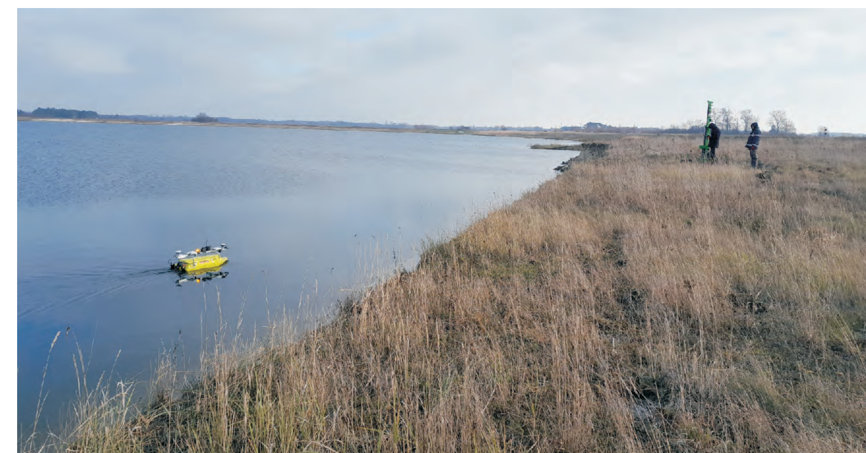
Prace badawcze na zbiorniku. Pomiary batymetryczne dna oraz sondowania dynamiczne
