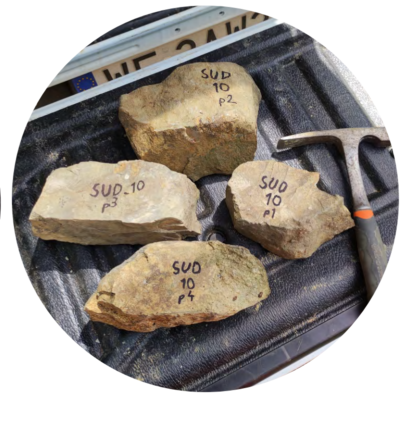
Pobór próbek skalnych na badania wilgotności oraz gęstości objętościowej
