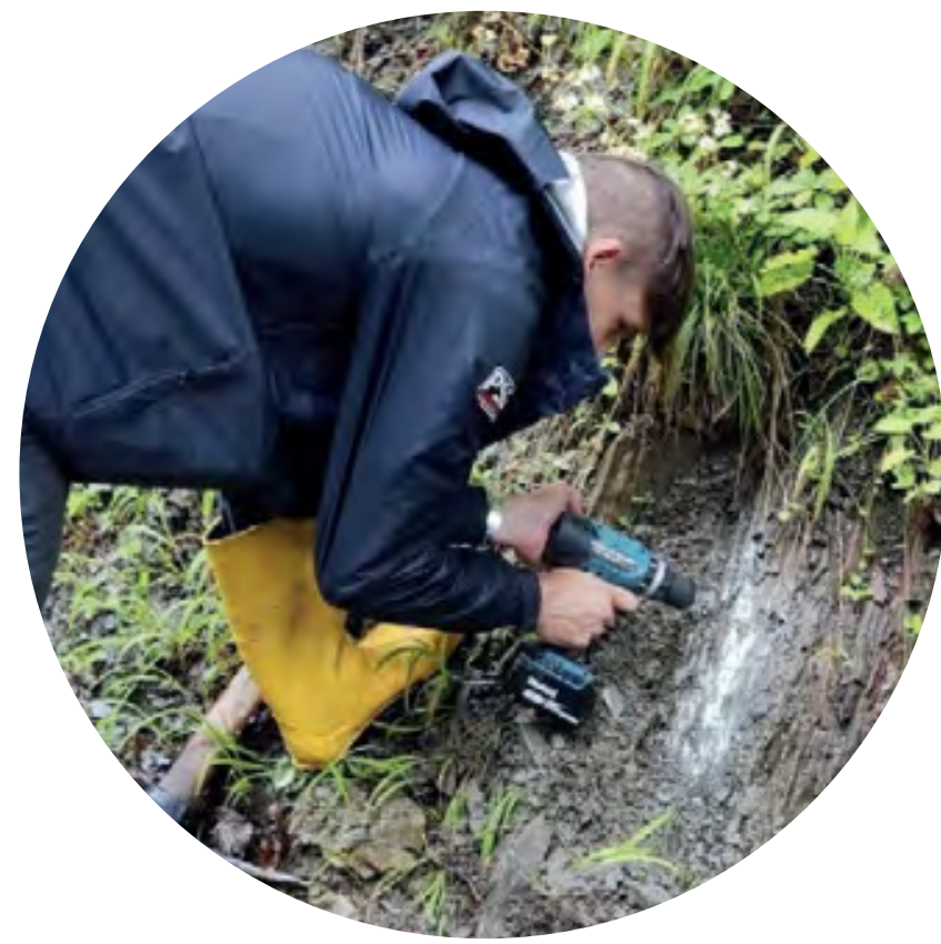
Nawiercanie otworu badawczego w skałe
