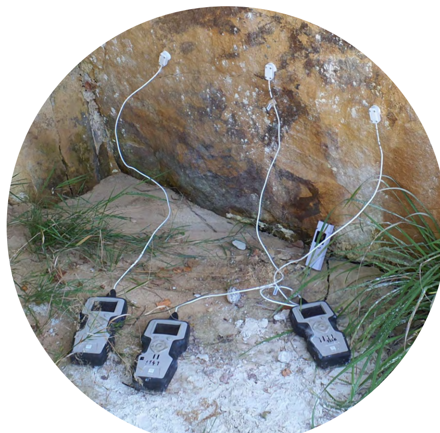
Przeprowadzanie badania przewodności igłą termiczną w skałe
