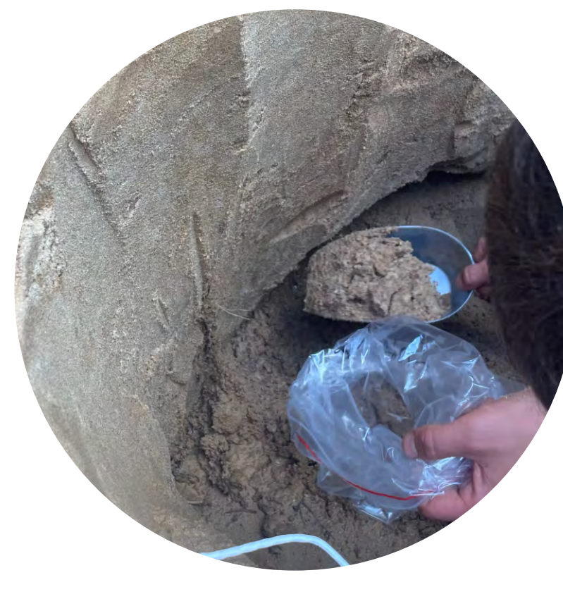
Pobór próbki gruntu na badanie wilgotności
