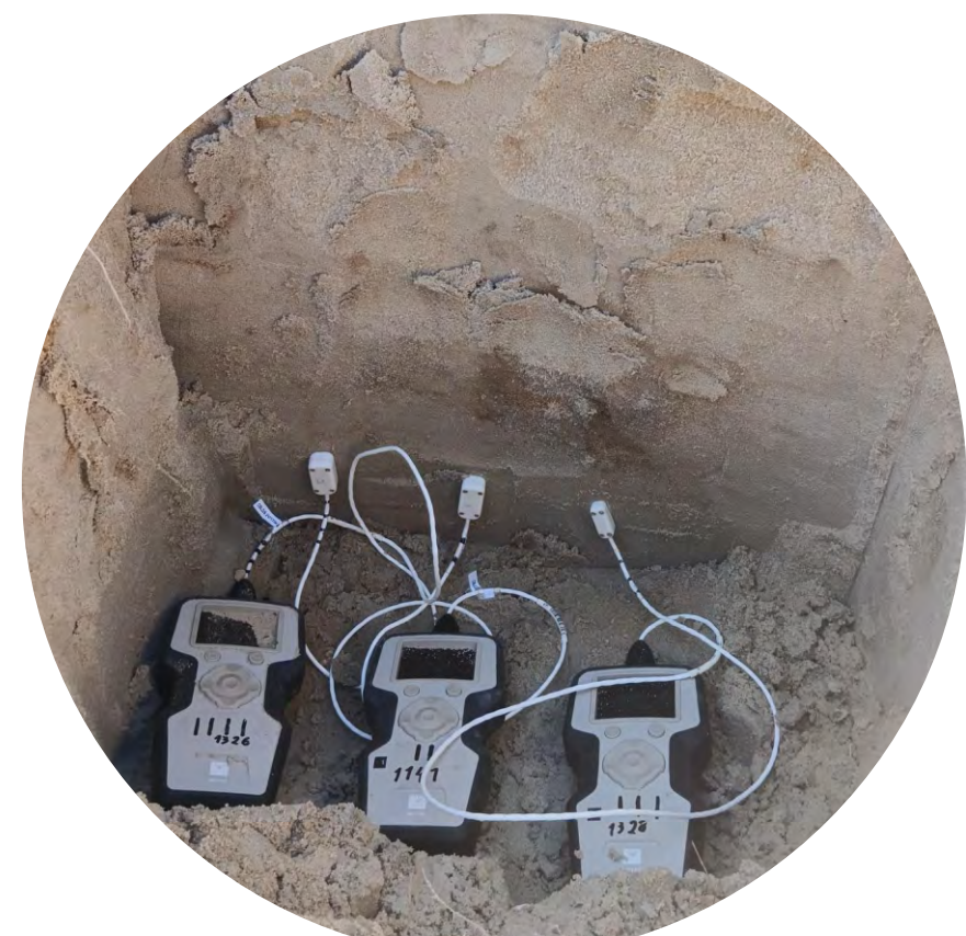
Przeprowadzanie badania przewodności igłą termiczną w gruncie
