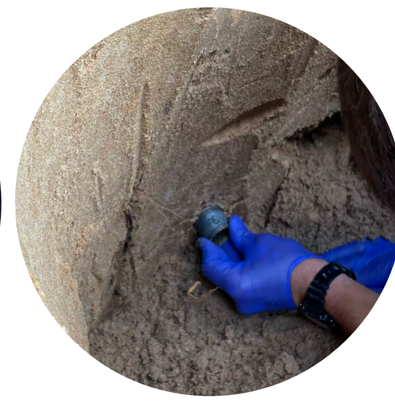
Pobór próbki gruntu na badanie gęstości objętościowej
