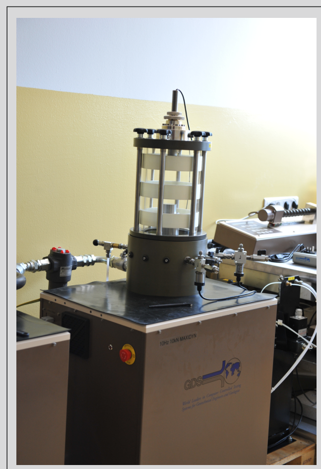
Zestaw do badań dynamicznych trójosiowych TXT, fot. Marta Szlaska
