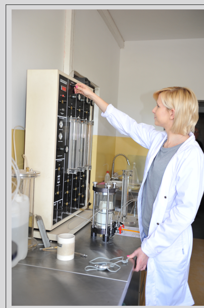
Panel do systemu pomiarowego „Trautwein” do badania współczynnika filtracji gruntów spoistych, fot. PIG-PIB
