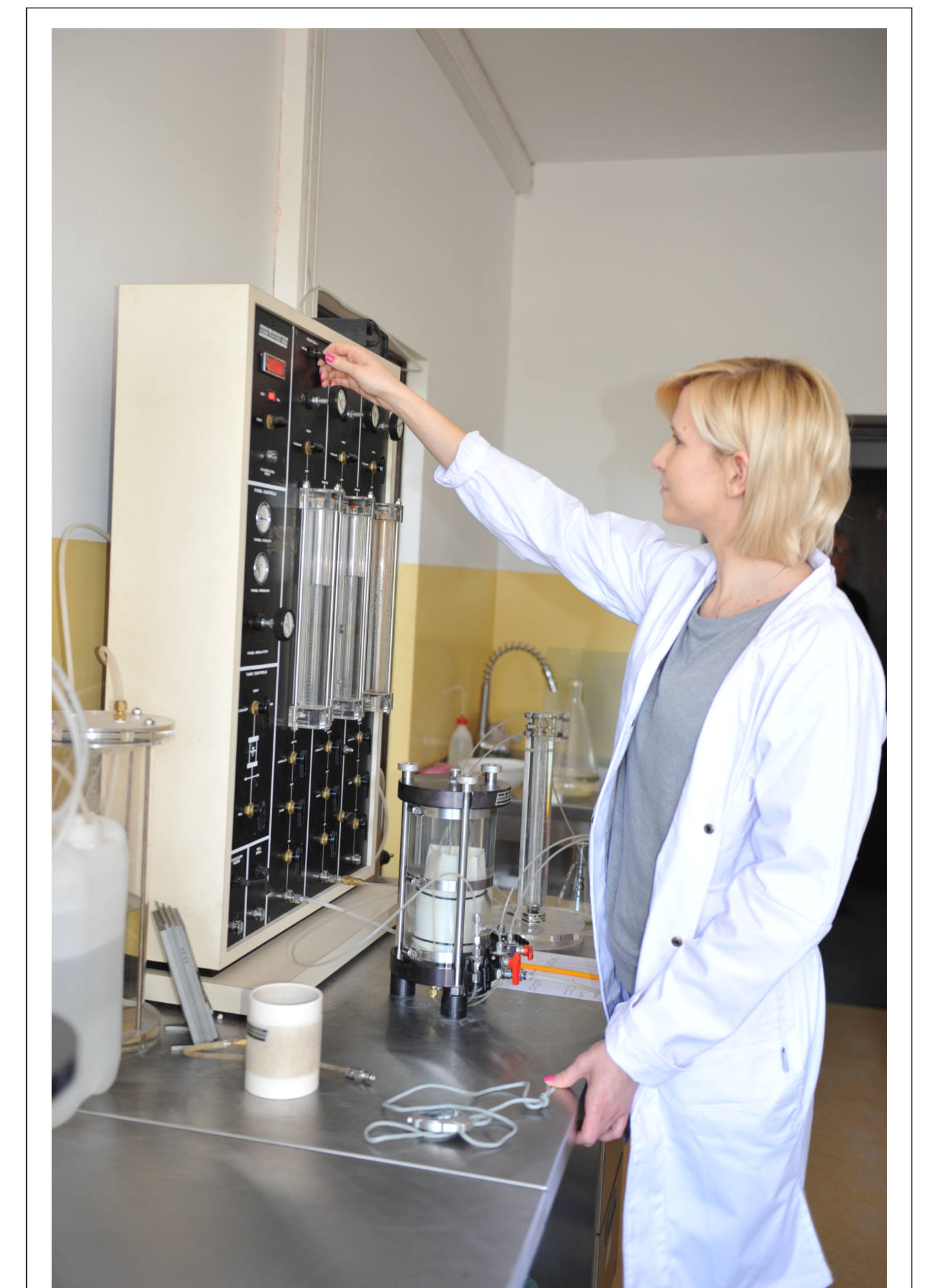
Figura 2. Panel do systemu pomiarowego „Trautwein” do badania współczynnika filtracji gruntów spoistych, fot. PIG-PIB
