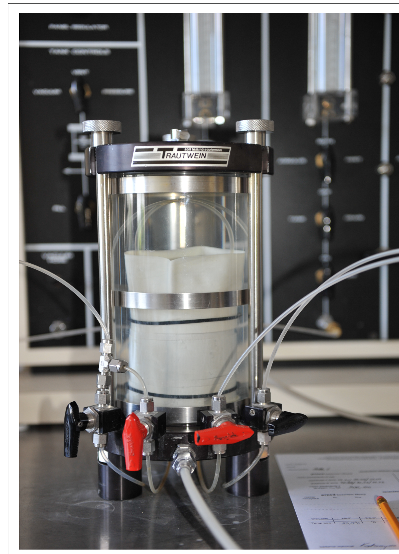
Figura 1. Komora do badań współczynnika filtracji, fot. PIG-PIB
