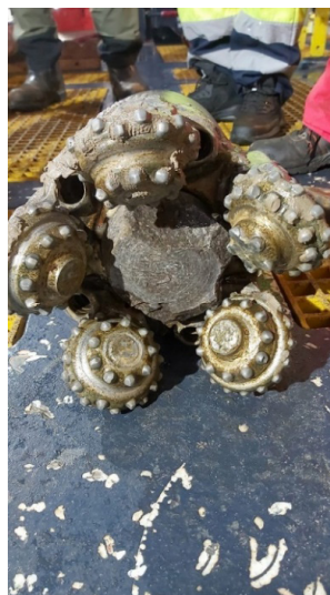
Ryc. 2. Koronka wiertnicza zatkana otoczakiem
