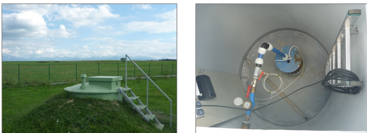
Ryc. 4.3. Stacja hydrogeologiczna I/847 Jabłonka (woj. małopolskie – widok otworu obserwacyjnego I/847/1 ogólny i wewnątrz obudowy)
