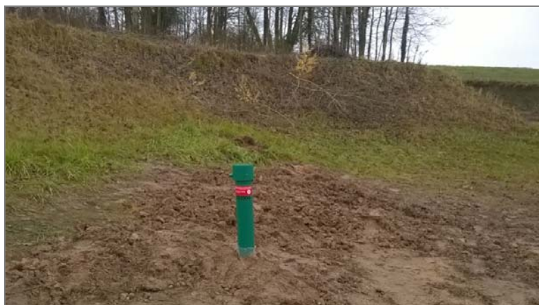
Ryc. 2.3. Piezometr nr 701004 monitoringu badawczego wód podziemnych w miejscowości Wilkajcie, wykonany w listopadzie 2017 r.
