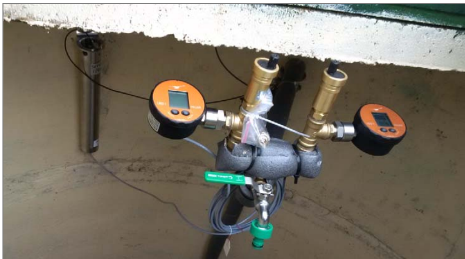
Ryc. 3.5. Rejestrator cyfrowy LEO-1 firmy Keller (manometr) połączony z modulem transmisji danych pomiarowych GSM-2 Keller - stacja hydrogeologiczna w Sepnie I/920/1
