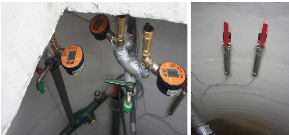
Ryc. 40.1 Stacja hydrogeologiczna I/470 Podlesie (woj. śląskie) – zestaw automatyki pomiarowej w otworach obserwacyjnych numer 2 i 4: manometry cyfrowe Leo 1 i rejestratory z transmisją danych GSM-2
