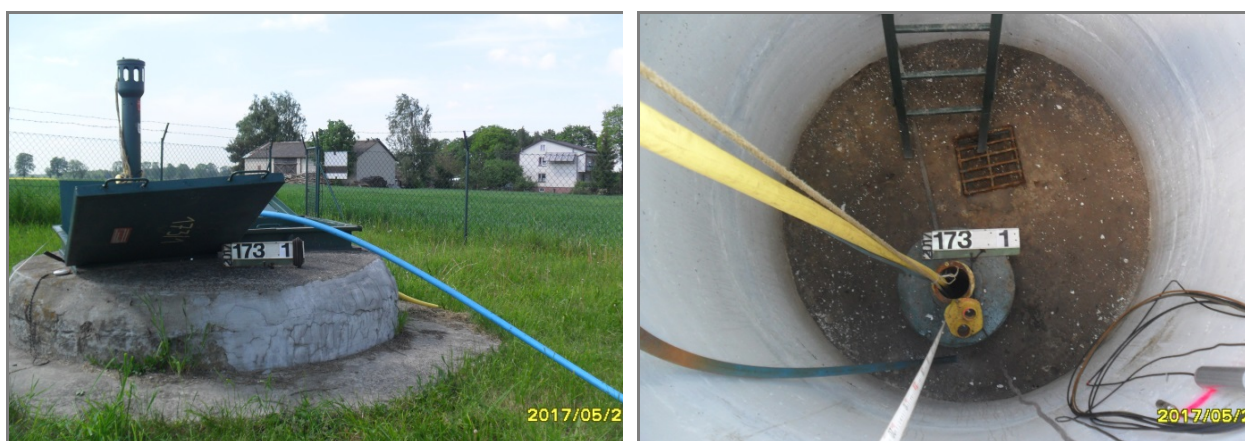
Ryc. 1.2. Otwór obserwacyjny nr I/173/1-J3 na stacji hydrogeologicznej Kuraszew (woj. lubelskie) w trakcie prowadzenia pompowania oczyszczająco - kontrolnego sprzętem przewoźnym
