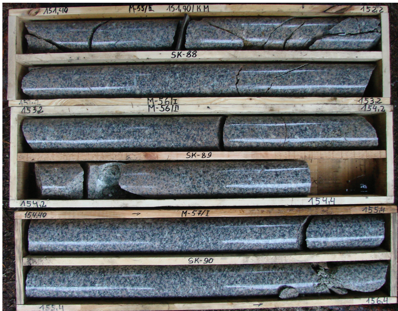
Fig. 3. Przykładowy odcinek rdzenia pobranego z otworu Czerwony Potok PIG 1 (głęb. 151,4–156,4 m; granitoid średnio-grubokrystaliczny; Habryn, 2012)
