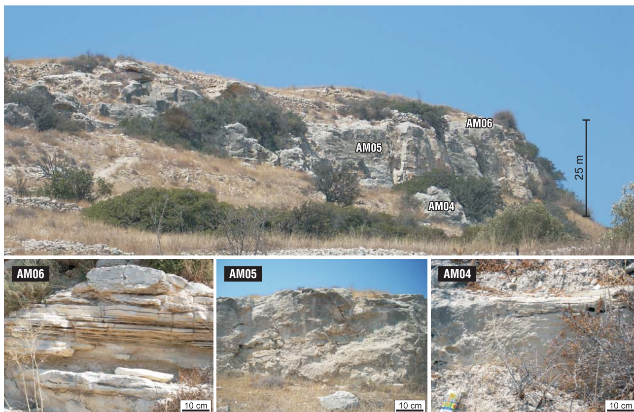
Ryc. 5. Profil z Amathus, pozostałość dawnego klifu. Zróżnicowanie warstw wapieni: porowaty biomikrosparyt (AM06), biomikryt z cechami kierunkowymi (AM05), masywny biomikrosparyt (AM04). Obie fot. M. Dzwoniarek Fig. 5. Amathus section, the remains of the old cliff. Diversity within the limestone layers: porous biomicrosparite (AM06), biomicrite with directional features (AM05), massive biomicrite (AM04). Both photos by M. Dzwoniarek
