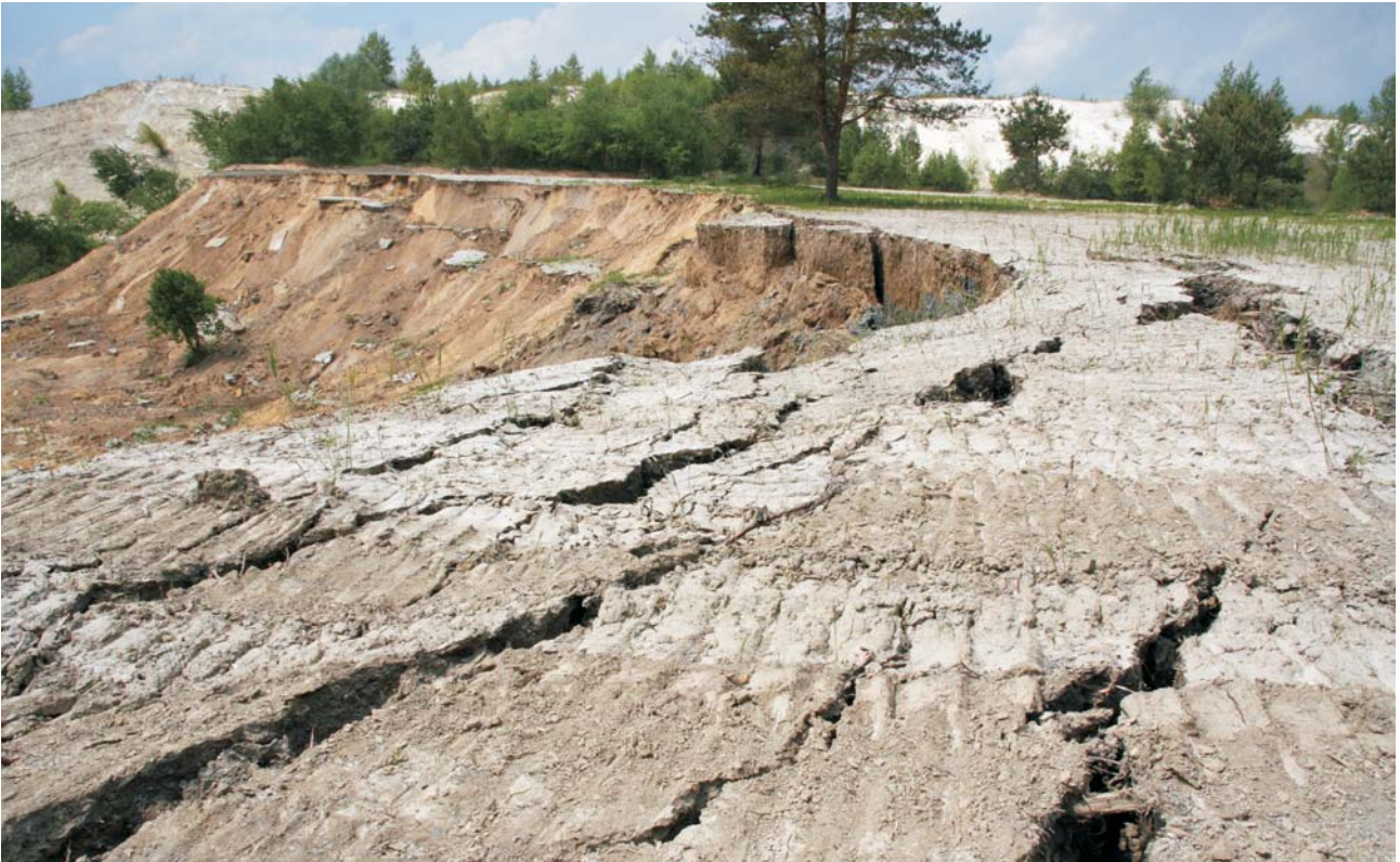
Ryc. 8. Górna krawędź osuwiska powstałego na zachodniej skarpie zbiornika wodnego „Piaseczno” w okolicach Tarnobrzega Fig. 8. Upper edge of the landslide on western escarpment of "Piaseczno" water reservoir near Tarnobrzeg
