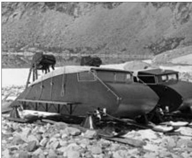
Ryc. 6. Sanie motorowe użyte podczas wyprawy Alfreda Wegenera na Grenlandię w 1930 r. ( www.ilsussidiarion.net )
