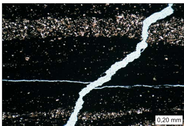
Ryc. 4. Fragment iłowca z przecinającymi się otwartymi mikrospęknięciami (niebieski kolor żywicy), bez analizatora, Narol IG 1, głęb. 3250,2 m
