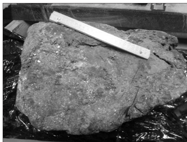
Ryc. 2. Monolit iłu mioplioceniowego pobrany podczas budowy stacji Centrum Nauki Kopernik II linii metra w Warszawie Fig. 2. Monolith of Mio-Pliocene clay obtained during the construction of the Copernicus Science Centre metro station in Warsaw
