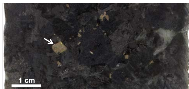
Ryc. 5. Fotografia archiwalnej części rdzenia wiertniczego pochodząca z interwału wzbogaconego w siarczki (por. tekst). Jedna z próbek (U1473A-80R-7-W 112/115-CIAZ) do badań poekspedycyjnych została pobrana z tego miejsca. Dominującym siarczkiem jest pirotyt (brązowe zabarwienie), a uzupełniającym chalkopiryty (żółte zabarwienie)
