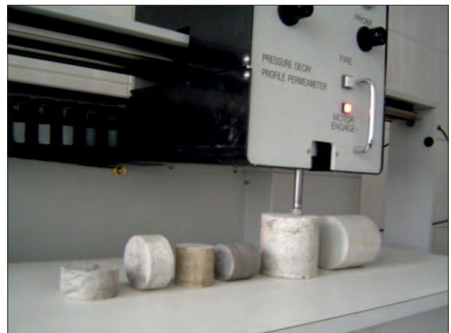
Ryc. 3. Przepuszczalnościomierz PDPK-400: głowica aparatu podczas badania próbki (Augustyniak i in., 2017)
