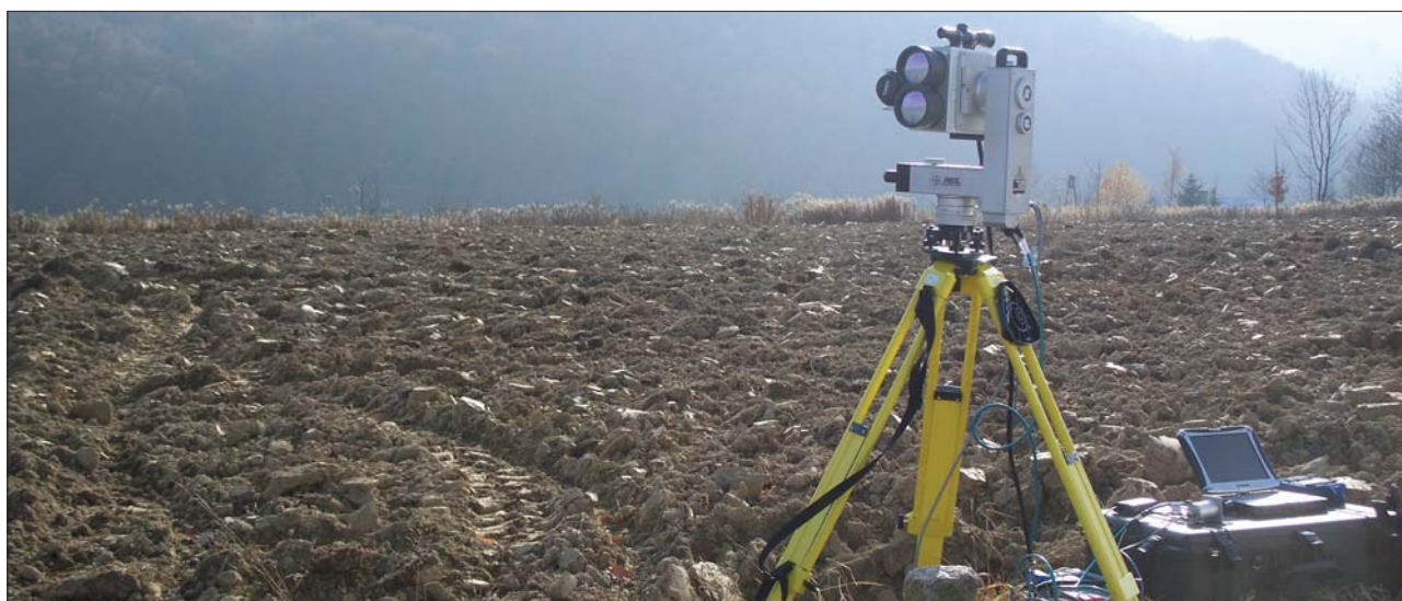
Wykonywanie pomiarów skanerem laserowym osuwiska w Łowczówku (gmina Pleśna, powiat tarnowski). Fot. Z. Perski Measuring a landslide in Łowczówek (Pleśna commune, tarnowski county) with terrestrial laser scanner. Photo by Z. Perski
