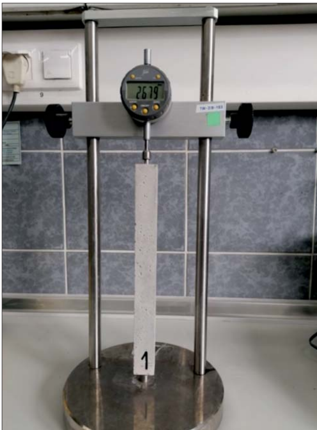
Ryc. 3. Pomiar długości beleczek betonowych za pomocą przyrządu Grafa-Kaufmanna wg PN-B-06714-34/A1:1997. Fot. Ł. Jórdeczka
