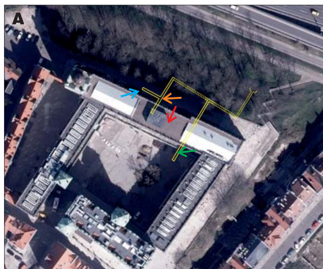
Ryc. 10. A – Widok z góry na Zamek Książąt Pomorskich – kolorem żółtym zaznaczono zarys potwierdzonej i prawdopodobnej obecności podziemnych tuneli w rejonie tarasu i skarpy (wg Godlewskiego i in. 2020a, b); B – wyniki inwentaryzacji tuneli metodą bezpośredniej eksploracji (Sokołowski, Olbrychowski, 2020) – czerwoną strzałką wskazano miejsce katastrofy i zapadlisko w ceglany tunelu
