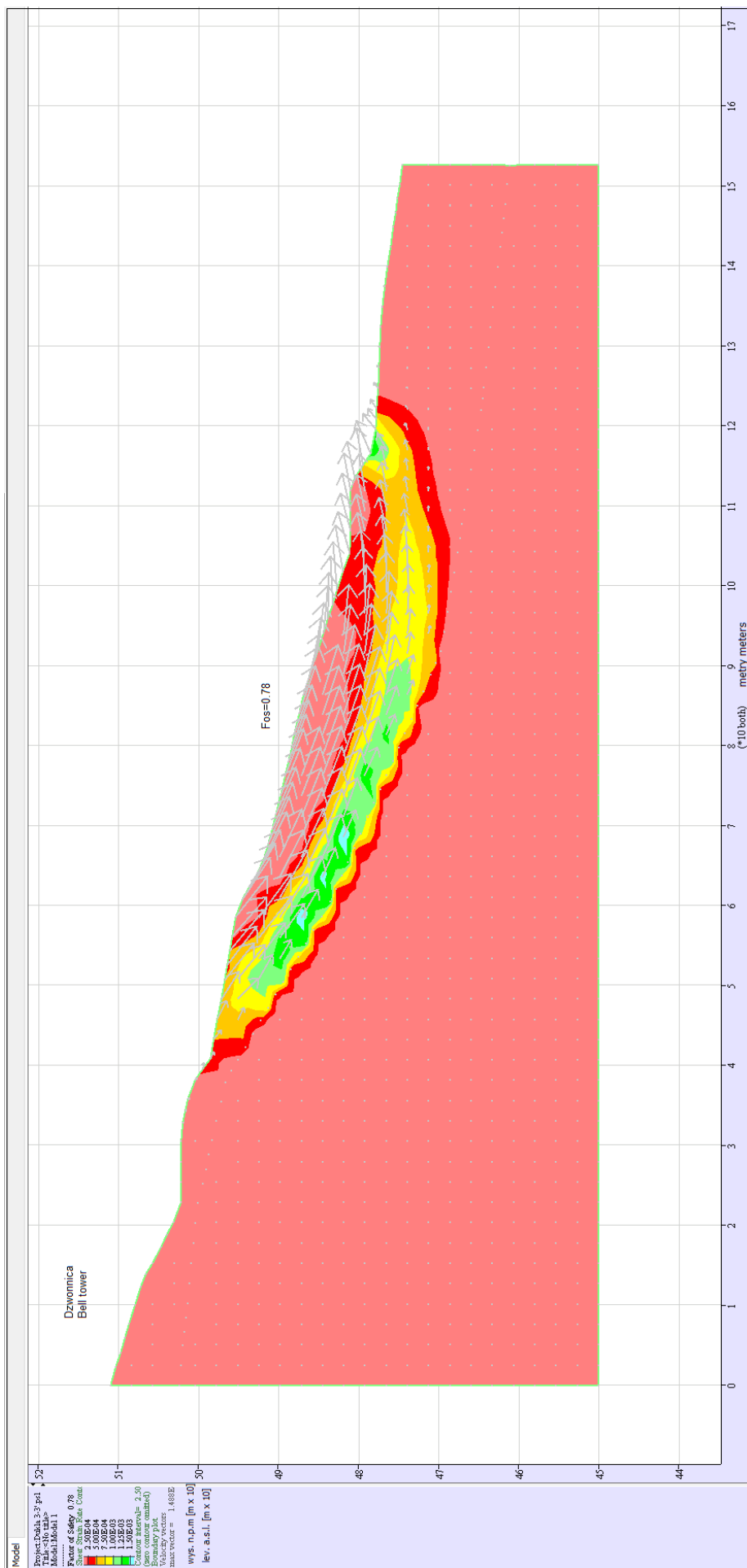
Ryc. 16. Analiza stateczności stoku wraz z dzwonnicyą bez zabezpieczenia stoku Fos = 0,78 Ryc. 16. Analysis of slope stability with bell tower without slope protection Fos = 0.78
