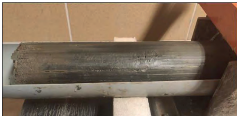
Ryc. 3. Próbkę gruntu po wypchnięciu z próbnika cienkościennego (fot. J. Rau) Fig. 3. Soil sample after pushing out of the thin-walled sampler (photo J. Rau)
